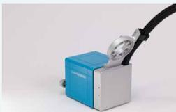
Beim Cobot wird der CLAMPBOOSTER zwischen ISO-Flansch und Greifer geschraubt. Beim Industrieroboter erfolgt die Montage direkt am Werkzeugflansch des Roboterarms.
