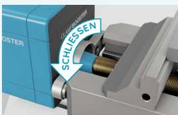
Nachdem der Roboter das Werkstück im Schraubstock platziert hat, führt der Roboterarm den CLAMPBOOSTER direkt zum Schraubstock. Der CLAMPBOOSTER schließt diesen entsprechend dem eingestellten Drehmoment.
