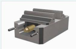
Der CLAMPBOOSTER setzt während des Schraubvorgangs an zwei Passstiften am Schraubstock an, so werden Torsionskräfte eliminiert und der Roboter arbeitet ohne Belastung. Die Bohrung für diese zwei Passstifte ist die einzig notwendige Vorbereitung des Schraubstocks.
