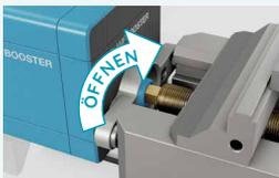
Nach der Bearbeitung in der Fräsmaschine öffnet der CLAMPBOOSTER den Schraubstock. Abschließend erfolgt die Entladung des Werkstücks durch den Roboter und der Produktionsprozess startet erneut (siehe Schritt 3).
